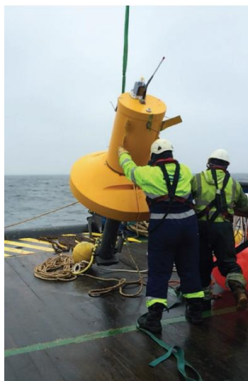
Figure 16 : La bouée acoustique RUBHY au moment de l'installation (source : SOMME).
